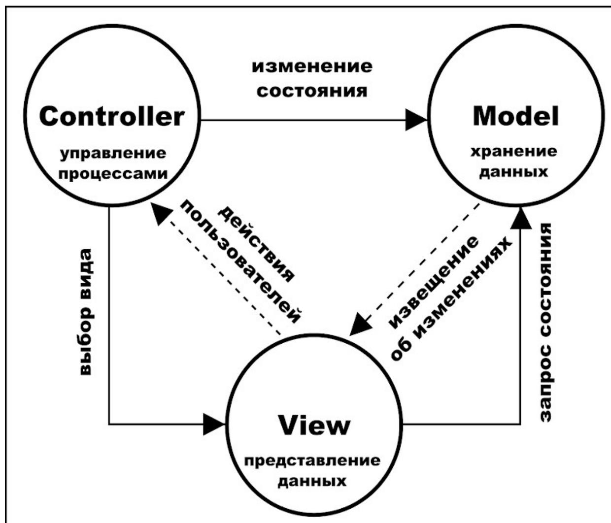
Рисунок 4.1 – Общая схема взаимодействия компонентов шаблона MVC
