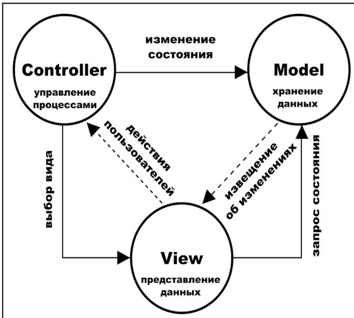
Рисунок Б.1 – Общая схема взаимодействия компонентов шаблона MVC
